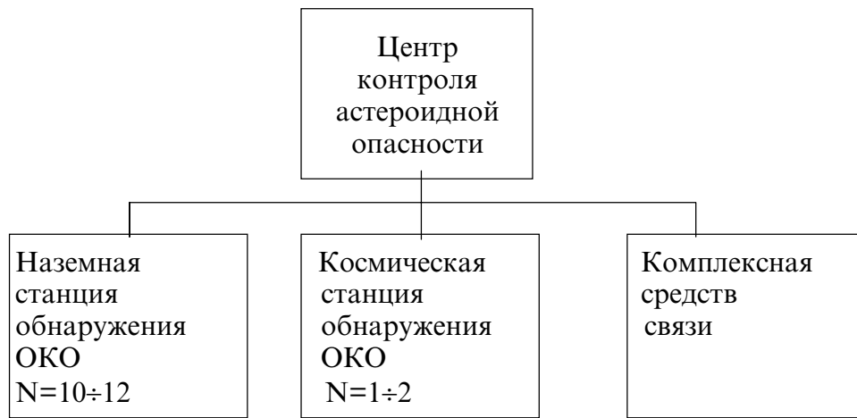
Рис. 3. Структурная схема оптико–электронного комплекса обнаружения опасных космических объектов.
